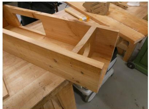
5. Im nächsten Schritt werden die beiden Rückwände mit einem Abstand von ca. 4 cm zueinander angebracht. Dafür werden sie, wie schon die Front beidseitig verschraubt. Um im Kasten für eine gute Durchlüftung zu sorgen ist die innerer Rückwand bündig mit dem Boden, die äußere Rückwand bündig mit dem Deckel.
