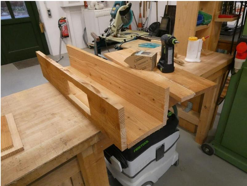
4. Nun wird das Einflugloch, mit einem geeigneten Bohrkopf, wie abgebildet in die Front gebohrt. Alternativ kann das Einflugloch auch mit einer Stichsäge ausgeschnitten werden. Die Front wird nun mit dem Boden und den Seiten verschraubt. Dabei wird sie um 10 cm nach hinten versetzt, beidseitig im Kasten mit vier Schrauben angebracht.
